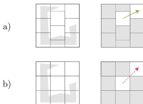
Obr. 3: Odlišná reprezentace prostředí mřížkou s posunutými buňkami (podle [35])
