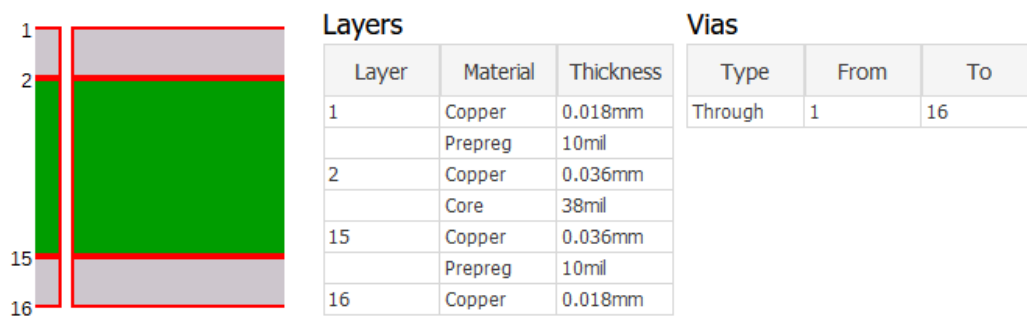
Obrázek 5.7: Parametry výsledné desky plošných spojů
