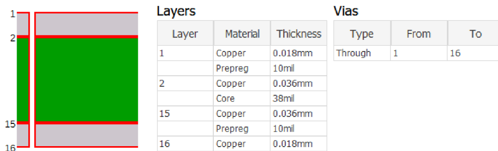
Obrázek 5.7: Parametry výsledné desky plošných spojů
