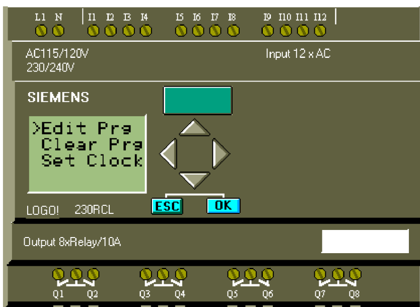
Obr. 2-6 Logický modul LOGO! 230RCL – prevzaté z [9]
