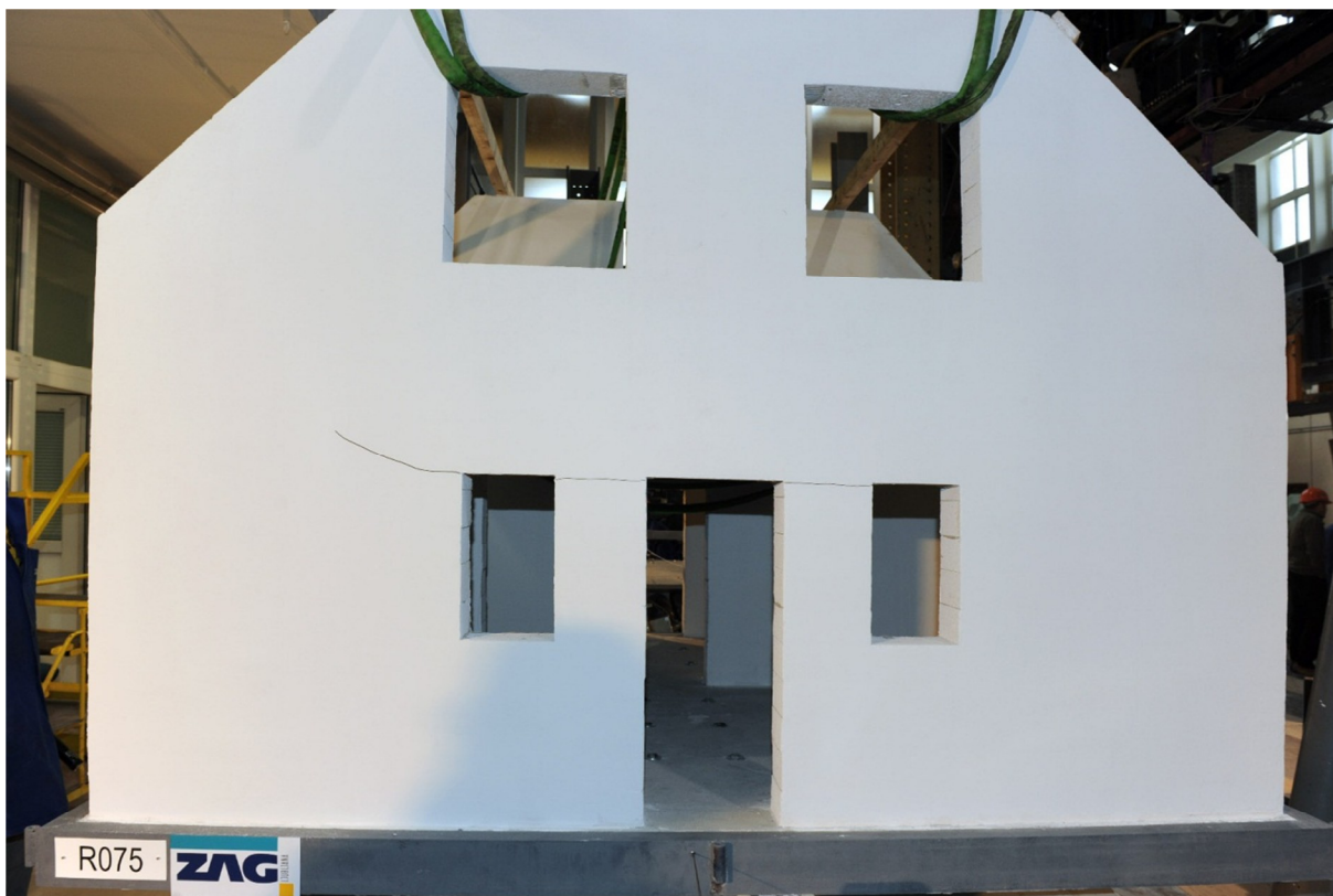
Obr. P5.1 Porušení při zatížení na úrovni G075
