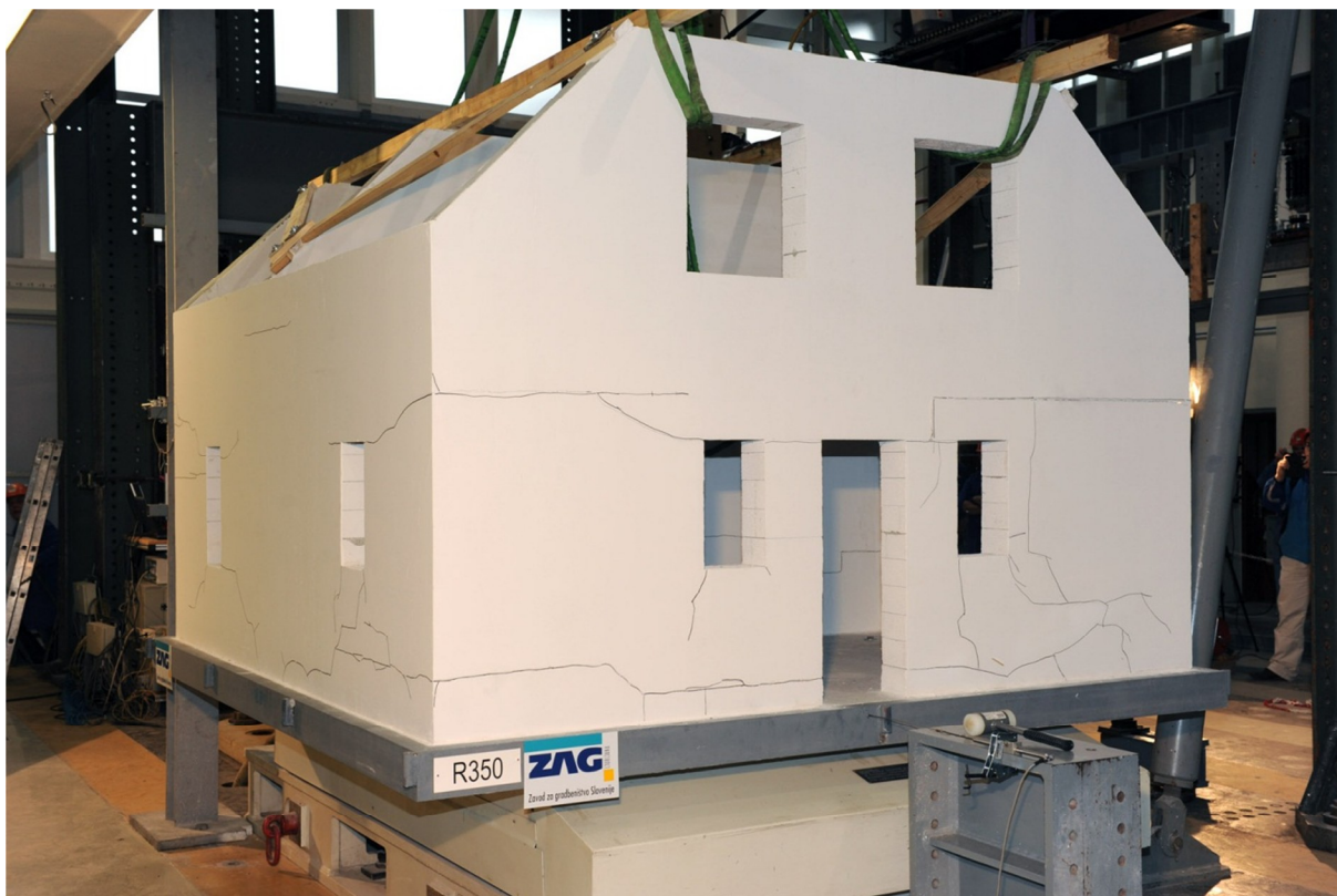
Obr. P5.5 Porušení při zatížení na úrovni G350
