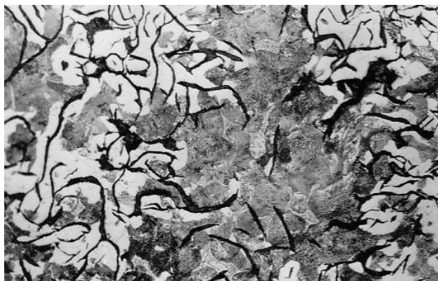
Obr. 2-15 Feriticko-perlitická struktura litiny s lupínkovým grafitem, [10]
