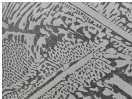
Obr. 2-5 Struktura bílé litiny, [13]
