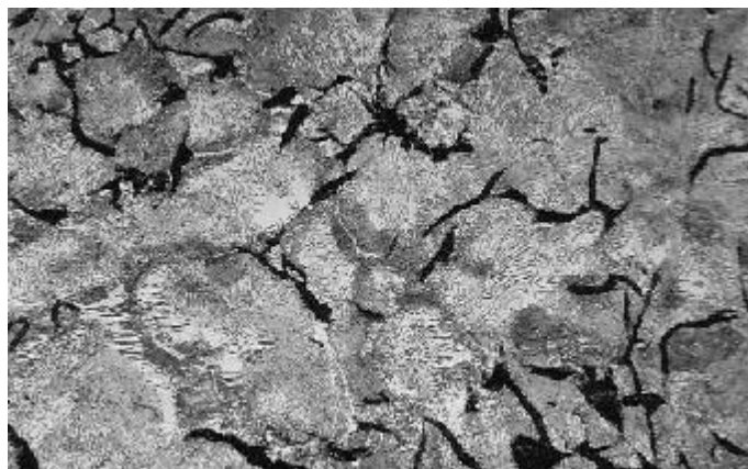
Obr. 2-14 Struktura perlitické litiny s lupínkovým grafitem, [10]
