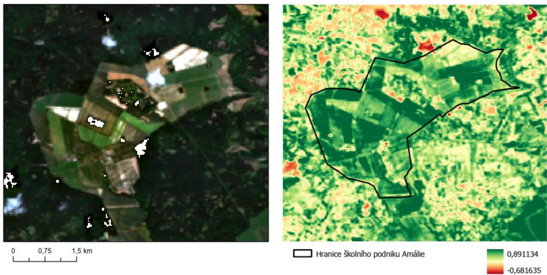
Obr. 22: Výsledný narrowband NDVI index ze senzoru PRISMA
