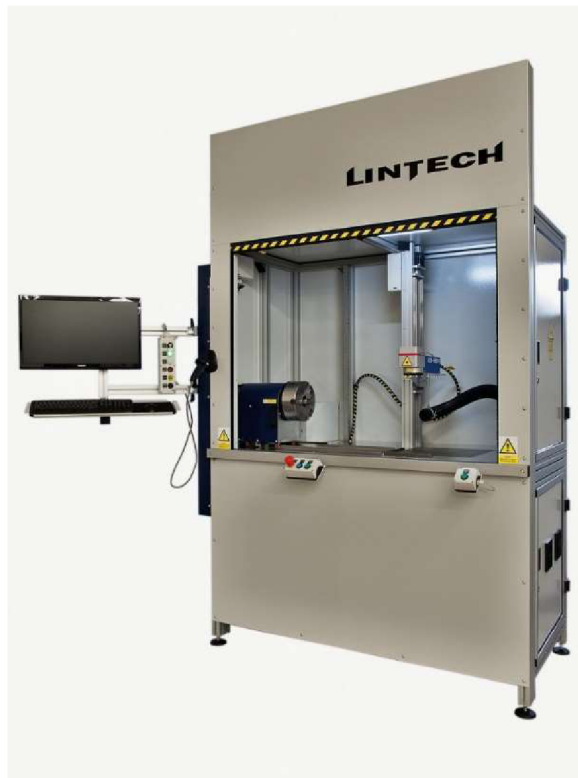
Obr. 12) Univerzální laserová stanice s rotační osou Lintech (9)
