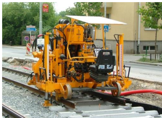
Obr. 60 Podbíječka Minima II [91].
