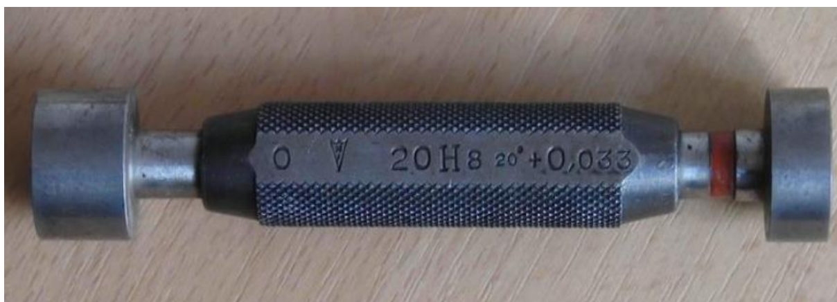
Obr. 56 Válečkový kalibr pro kontrolu rozměru 20H8 [84].
