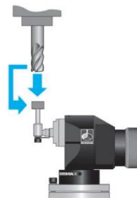
Obr. 21 Schéma kontaktní nástrojové sondy [33].
