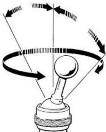
Obr. 49 Možnosti polohování kalibrační koule [72].
