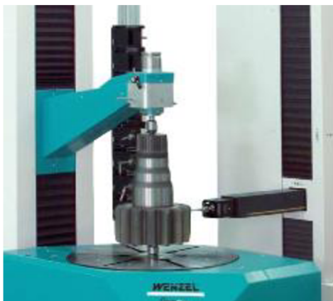
Obr. 44 Detail způsobu upínání [66].
