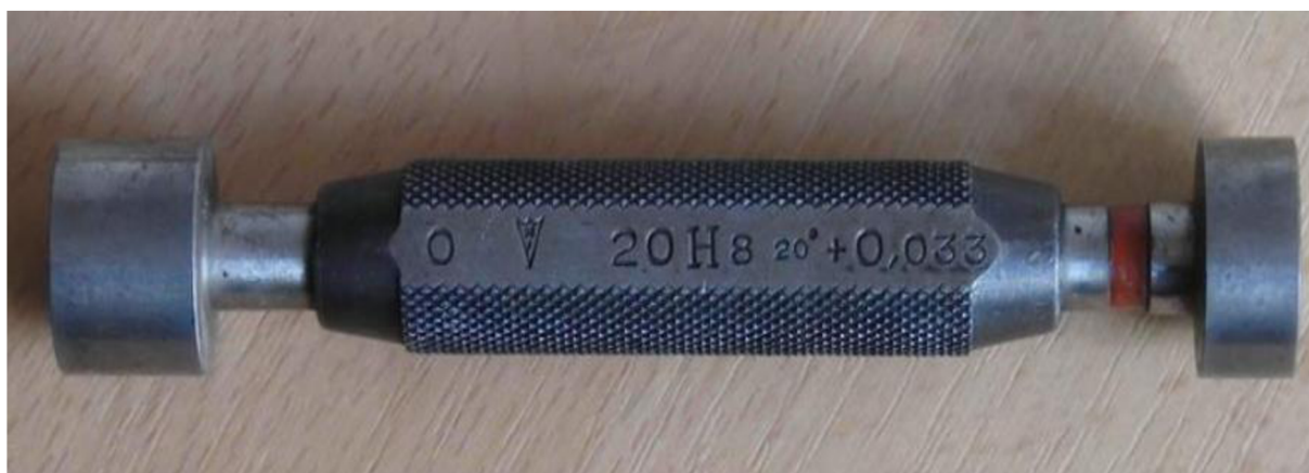
Obr. 56 Válečkový kalibr pro kontrolu rozměru 20H8 [84].
