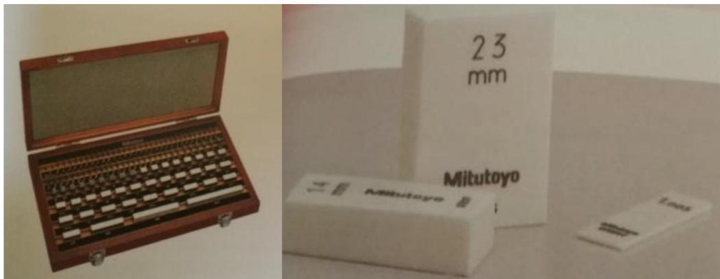
Obr. 57 Vlevo sada měrek, vpravo jednotlivé koncové měrky [14].
