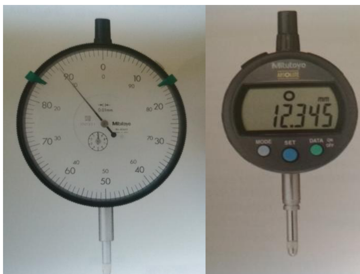
Obr. 54 Vlevo číselníkový, vpravo digitální úchylkoměr společnosti Mitutoyo [14].
