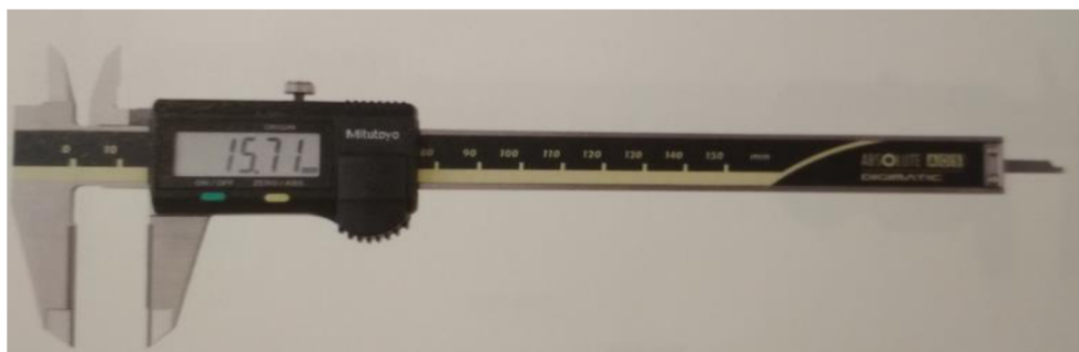
Obr. 53 Digitální posuvné měřítko společnosti Mitutoyo [14].
