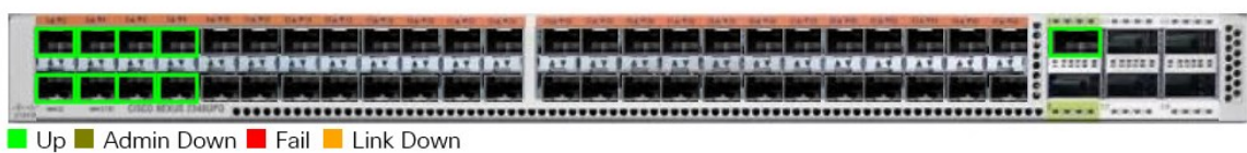
Obrázek 13: Fabric Extender (FEX)
