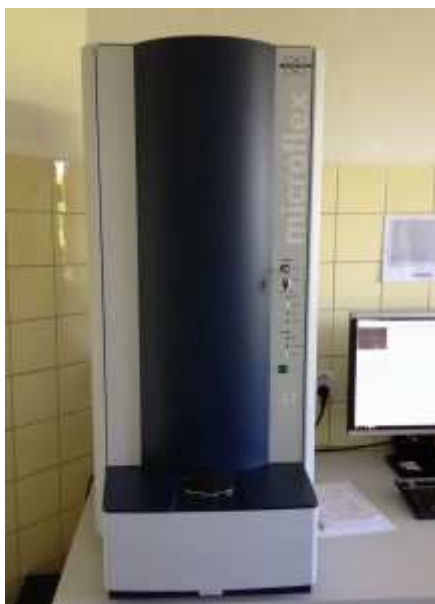
Obr. 14: MALDI-TOF (Centrální laboratoře nemocnice Tábor)
