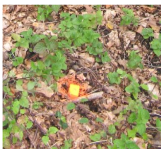
Obr. 6: Stabilizace bodu pomocné měřické sítě
