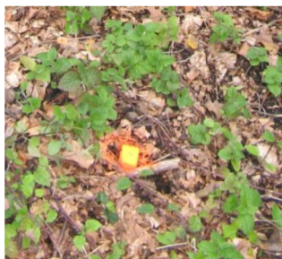
Obr. 6: Stabilizace bodu pomocné měřické sítě
