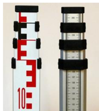
Obr. 11: Nivelační přístroj Topcon AT-G7 [25] Obr. 12: Teleskopická nivelační lať [26]
