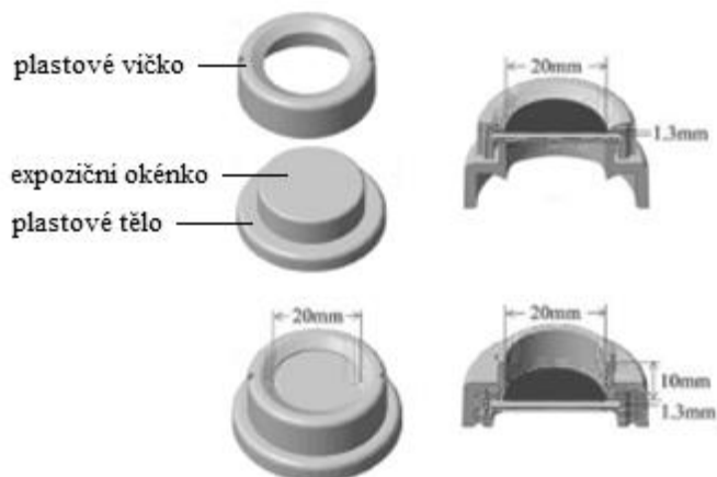
Obr. 2 Schematické znázornění vzorkovací jednotky včetně jejich rozměrů. Převzato a upraveno z [33]
