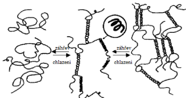
Obr. 9 Mechanismus tvorby gelu [50]
