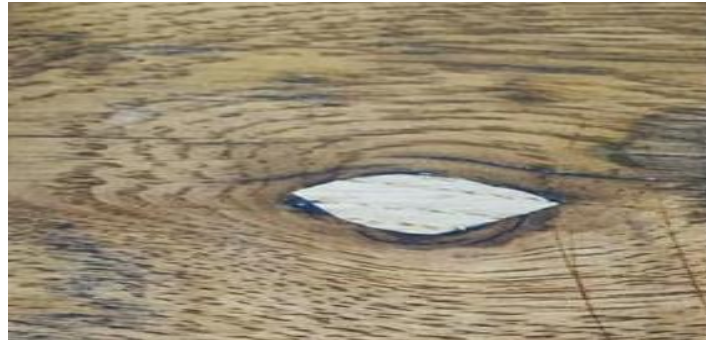
Obrázek 13 - Zaplnění otvoru po vypadlém suku v dubovém dřevě s porušením průběhu let
