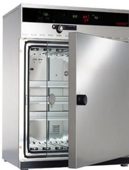
Obrázek 22 - Klimatizační komora Memmert – Verkon (zdroj: https://www.verkon.cz/komory-klimatizacni-memmert/ )
