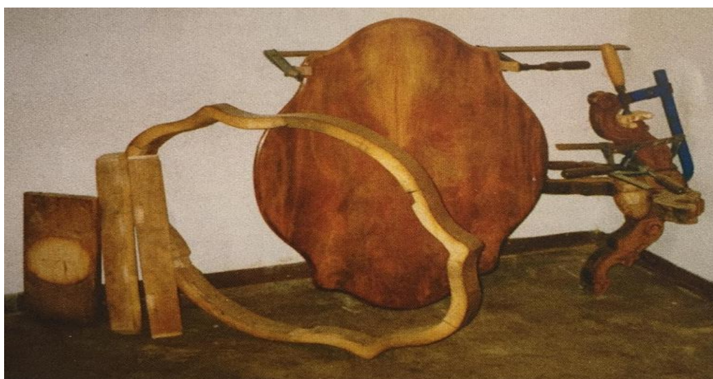
Obrázek 8 - Stažení stolní desky, mezi svorku a okra desky je třeba vložit měkkou podložku
