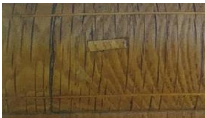
Obrázek 14 - Násilné přerušování průběhů letokruhu při restaurování (Losos, 2013)
