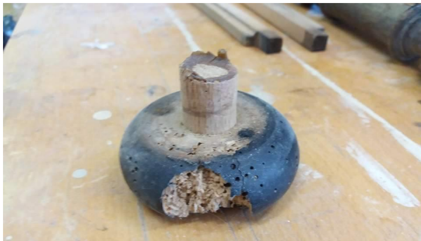
Obrázek 27 - Detail poškozené nohy stolu (Vlastní fotografie)
