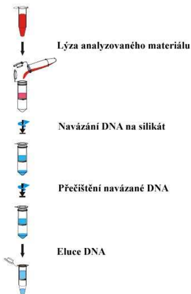
Obrázek 3 - Základní schéma izolace DNA silikátovou kolonkou.
