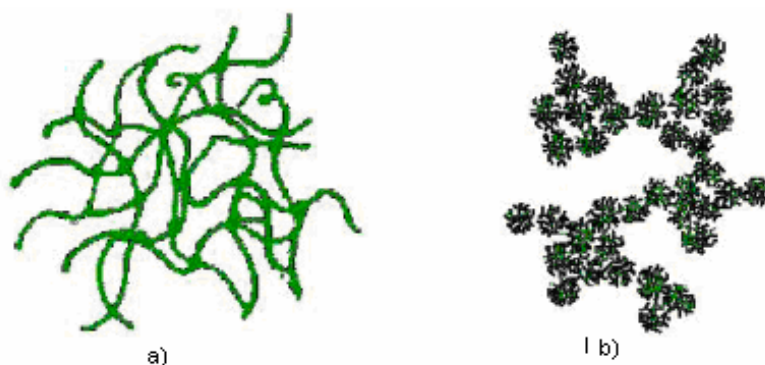
Obr.3.9: Struktura vzniklé sítě a) při kyselé katalýze b) při bazické katalýze
