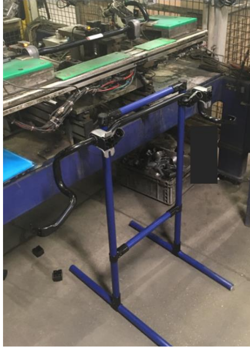
Obrázek č. 33: Stojan na odkládání stabilizátorů (Zdroj: Interní materiály společnosti)
