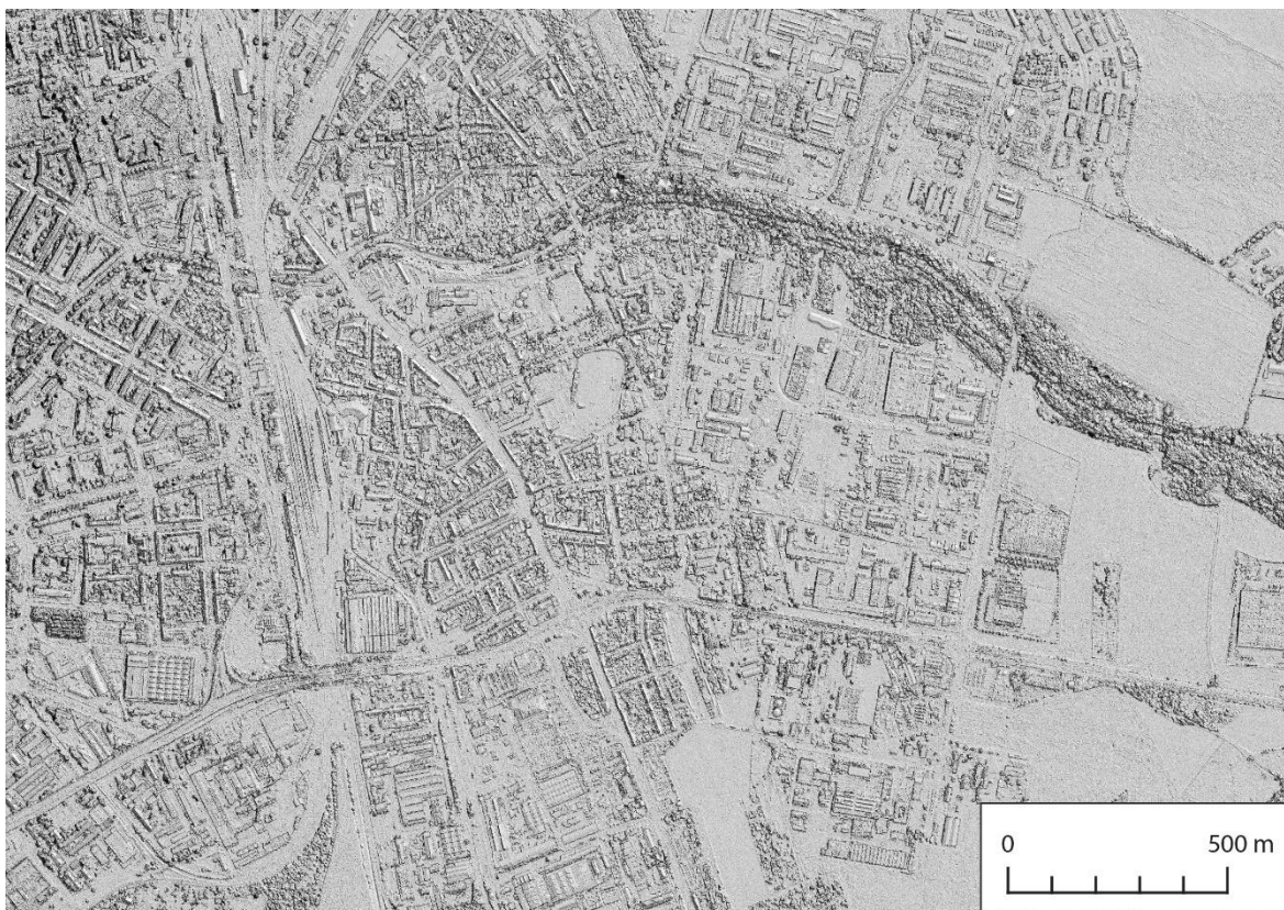
Obr. 34 Finální DMP z programu Agisoft Metashape ve formě stínovaného reliéfu.
