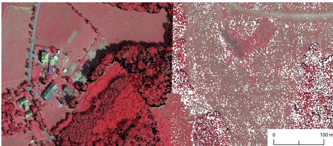
Obr. 11 Vizuální srovnání rozdílné hustoty bodových mračen z různých zdrojů.
