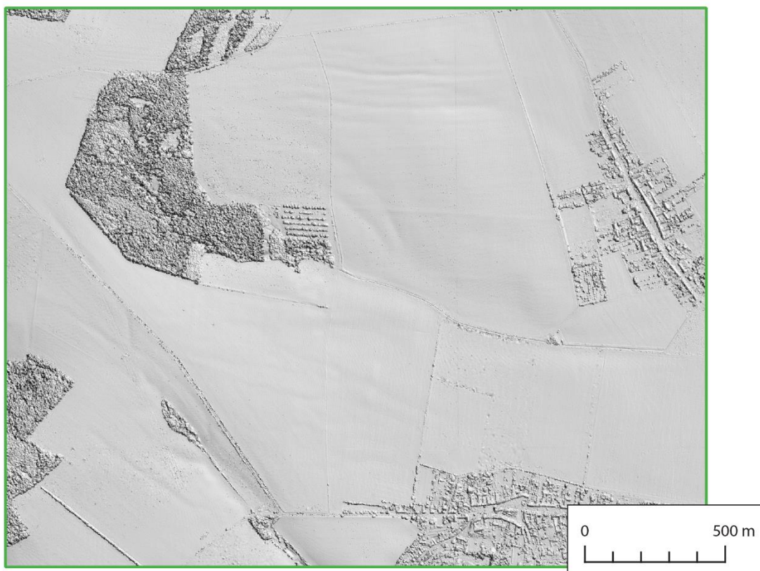
Obr. 36 DMP (stínovaný reliéf) z finálního způsobu spojení bodových mračen v překryvech.
