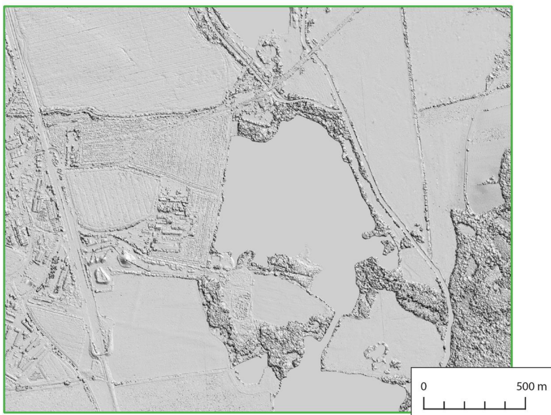
Obr. 38 DMP (stínovaný reliéf) – vytvořený z bodového mračka po opravě.
