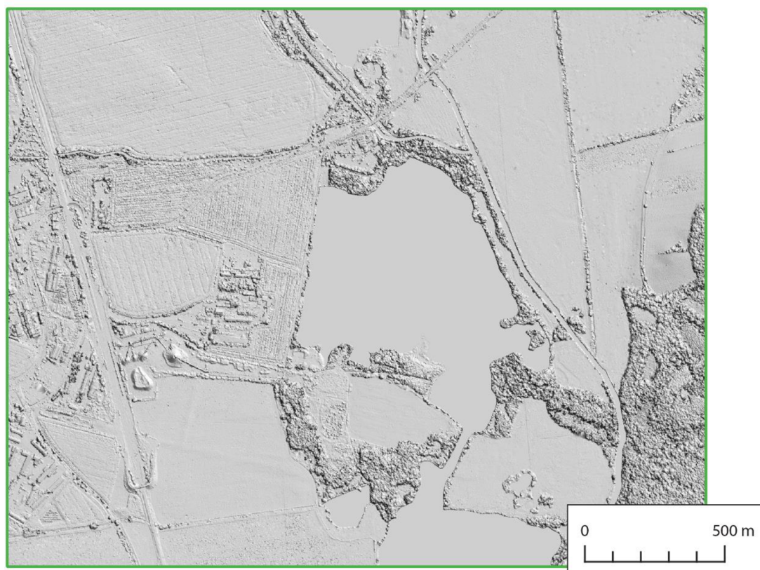
Obr. 21 Finální digitální model povrchu v podobě stínovaného reliéfu v bloku SM5 ZABR69.
