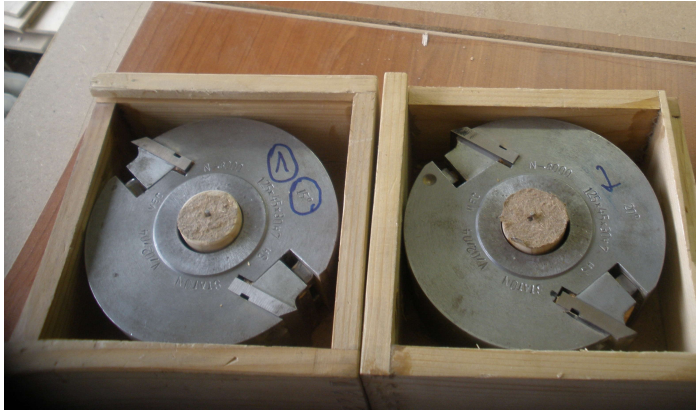
Obr. 30 Frézovací hlavy s úhlem čela 15°, 20° uložené v krytu po měření (autor)
