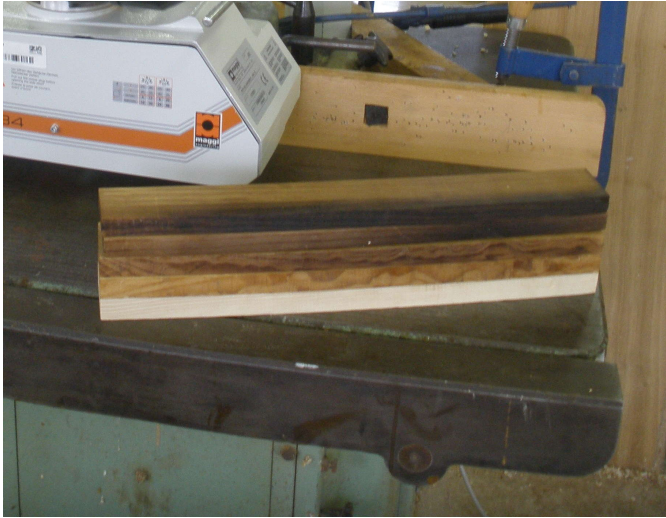
Obr. 32 Vzorky připravené k frézování (autor)
