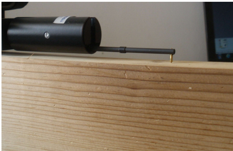
Obr. 36 Detail měřícího hrotu při měření (autor)
