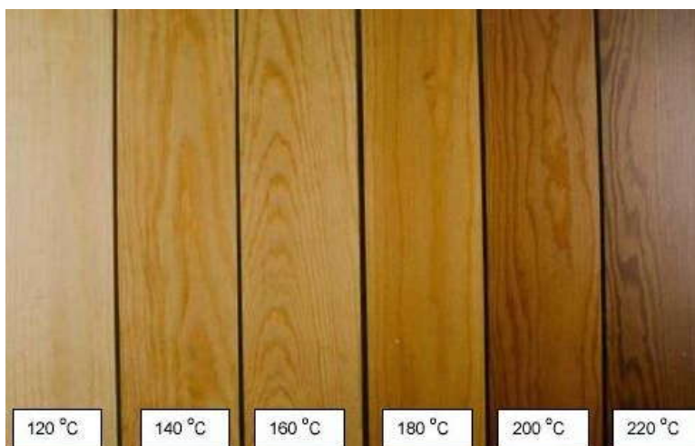
Obř. 7 Spektrum barev tepelně upravené borovice (120 -220 °C po 20 ° intervalech) (ThermoWood Handbook 2003)
