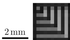
Obrázek 2.24: Výřez snímku binárního obrazce pro vysvětlení volby vertikálních proužků namísto horizontálních.
