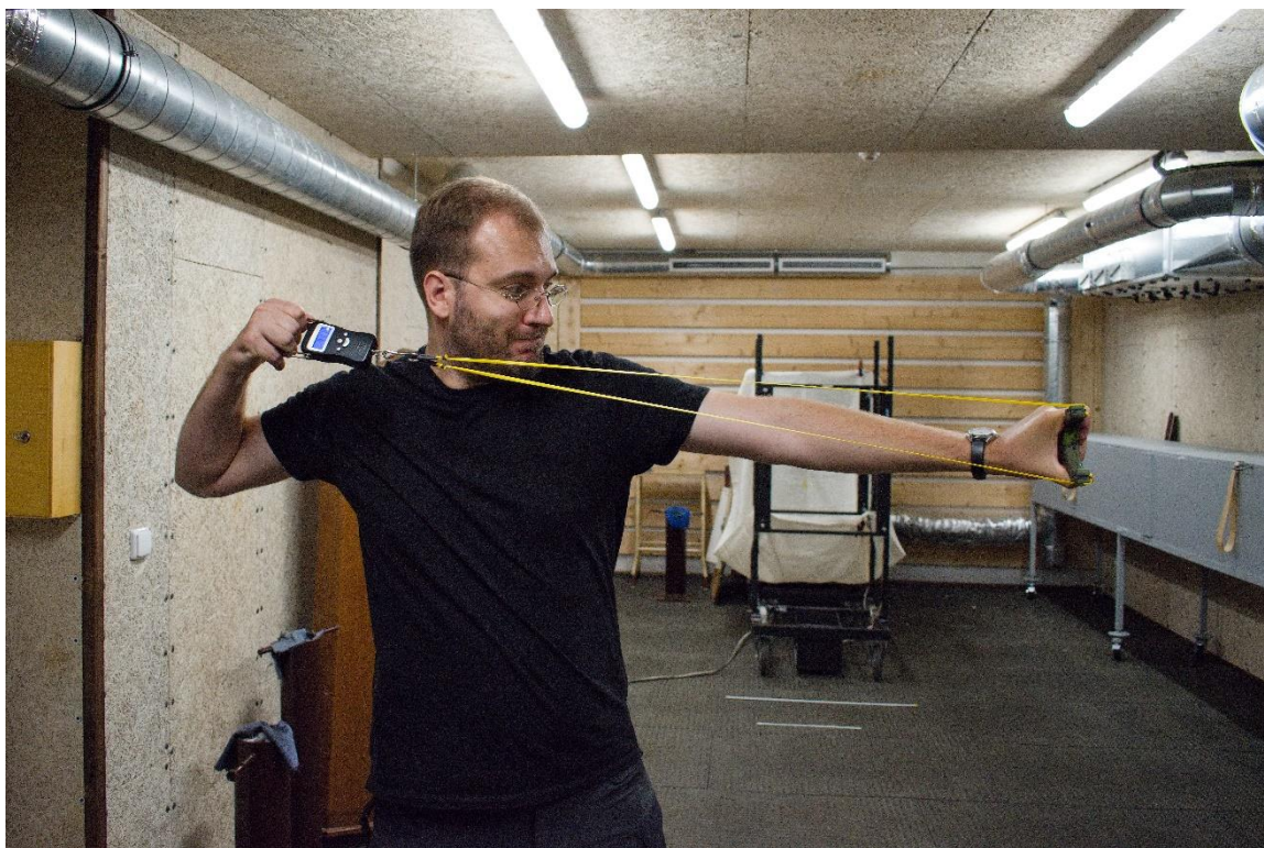
Obrázek 17 - fotografie měření náťahové síly gumy praku
