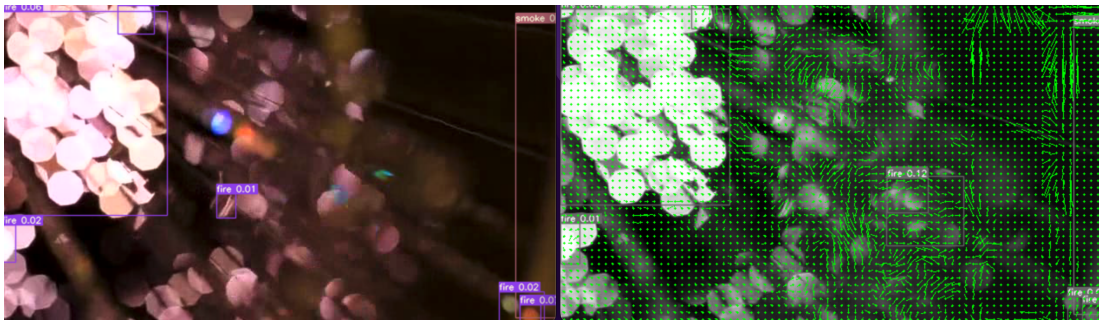
Obr. 2.11: Ukázka optického toku pro pozitivní a negativní detekci ohně
