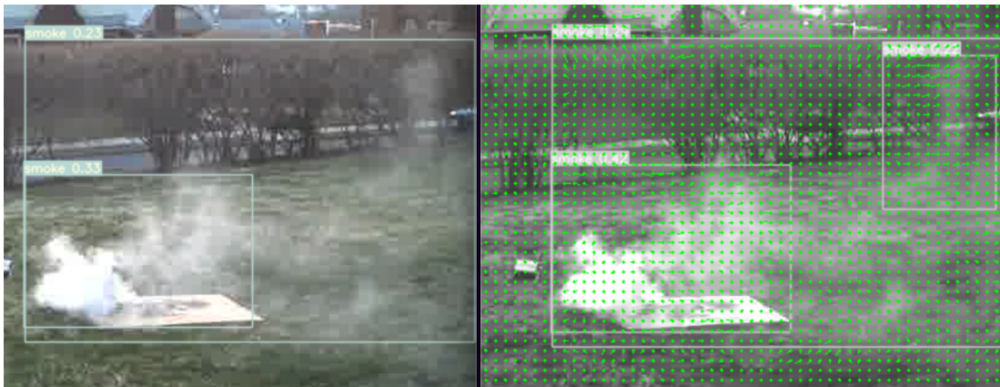
Obr. 2.12: Ukázka optického toku pro pozitivní detekci kouře
