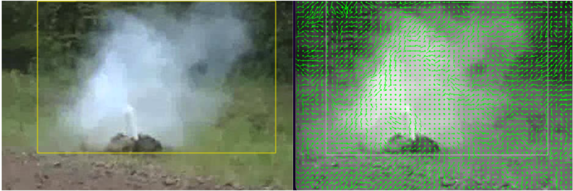
Obr. 2.14: Optický tok kouře při pohybujiícím se záběru
