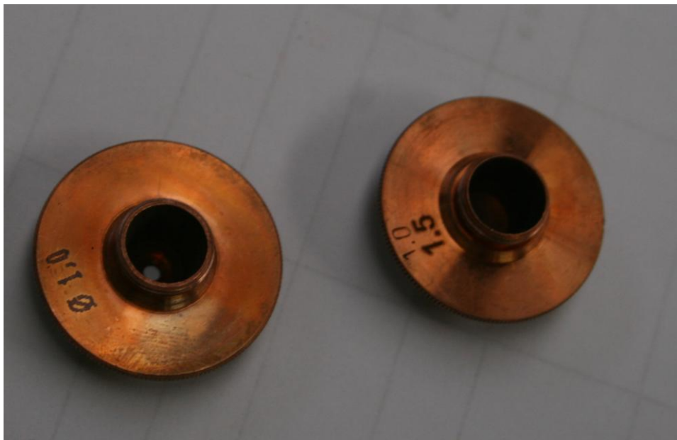
Obrázek č. 50.: měděná tryska laseru o průměru 1 a 1,5mm vlastní zdroj
