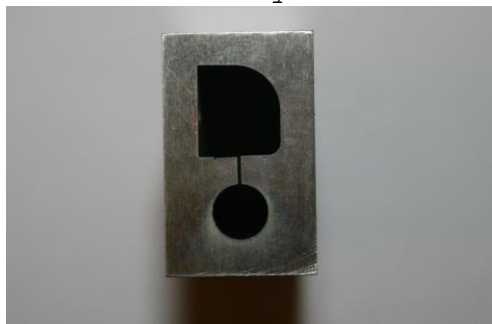
Obrázek č. 51: detail střižníku vyříznutého EDM metodou
