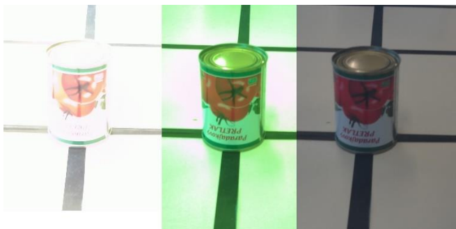
Obr. 28 Trojce snímků. Bez použití filtru, zelený filtr, neutrální filtr ND16.
