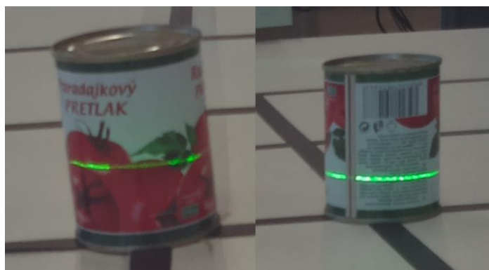
Obr. 24 Snímek objektů s použitím filtru ND16 a hloubkou expozice 700000uS
