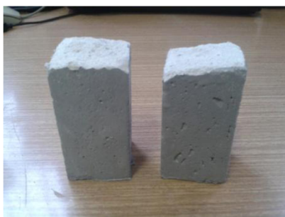
Obr. 22 Vzorky natřené těsnícím přípravkem
