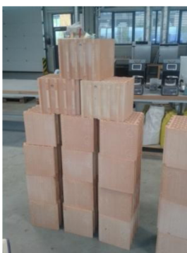
Obr. 24 Tvarovky přichystané na hydrofobizace pro zátopovou zkoušku
