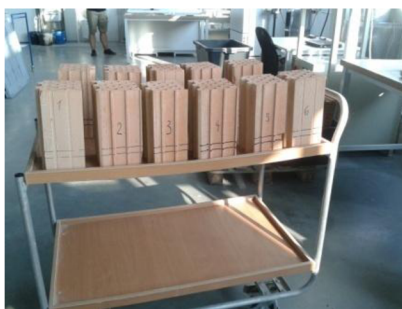
Obr. 16 Tvarovky připravené na hydrofobizaci
