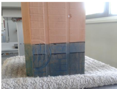
Obr. 19 Tvarovka opatřená hydrofobizérem v kombinaci s pigmentem
