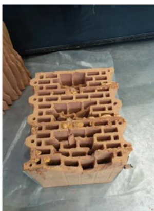
Obr. 36 Odebírání vzorků z tvarovky
