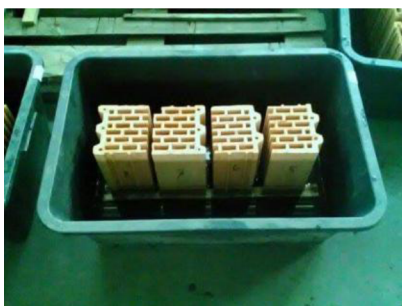
Obr. 17 Tvarovky zatopené vodou
