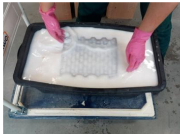
Obr. 25 Tvarovka namáčená v hydrofobizéru
