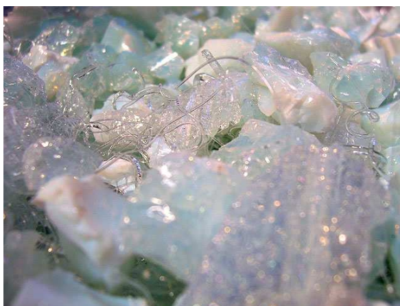
Obrázok 3: Frita vzniknutá ochladením roztaveného sklárskeho piesku s \text{Na}_2\text{CO} [39].
