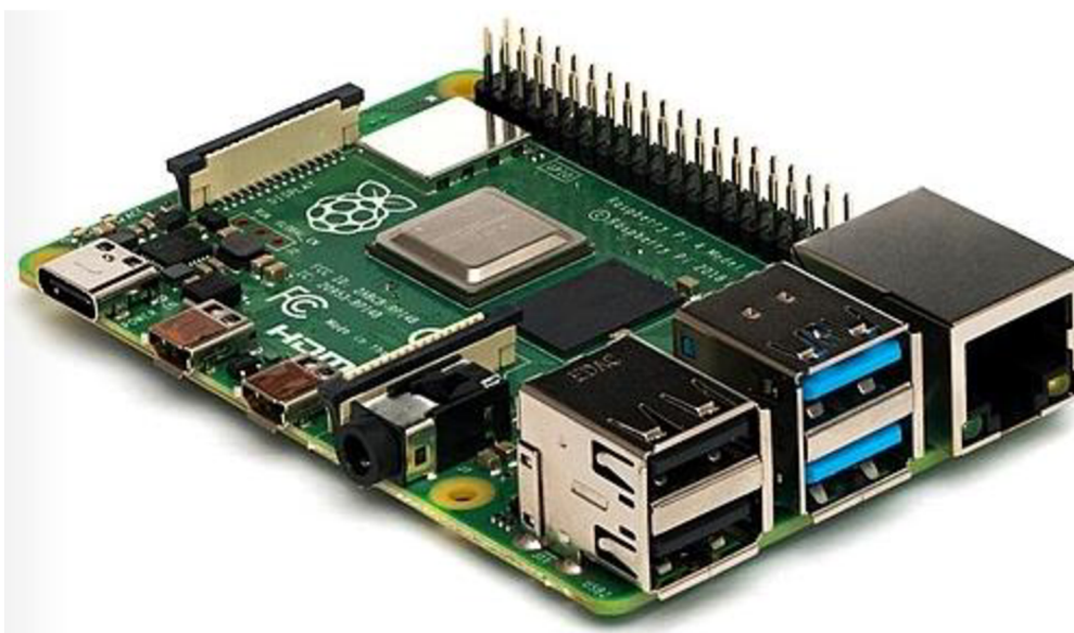
Obrázek 12. Raspberry Pi 4 model B [21]
