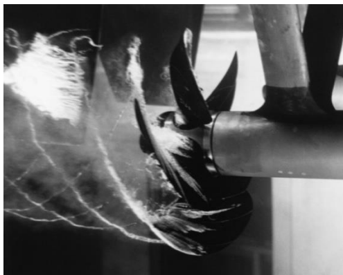
Obr. 15. Kavitace na lopatkách lodního šroubu. 13
