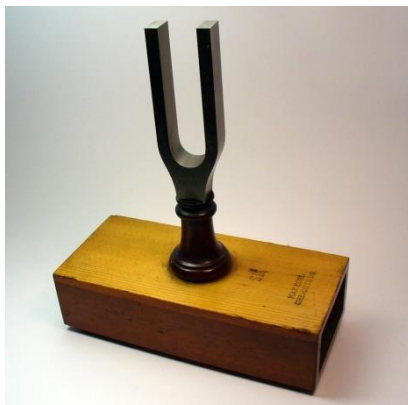
Obr. 10. Ladička s rezonanční skříňkou.
