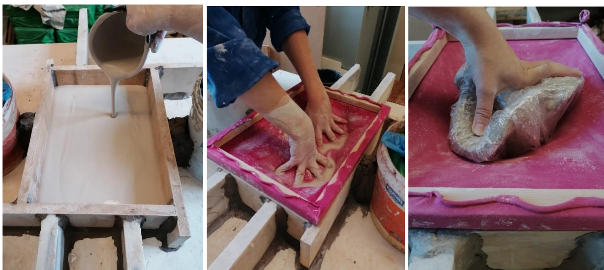
Obr. č. 26 – výroba sádrové formy, lití sádry do ohrádky . Foto: Anna Kubáňová
