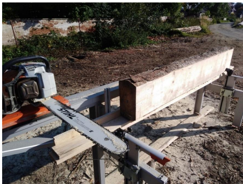
Obrázek 39 Třetí řez oříznutí krajiny, získání prisma
