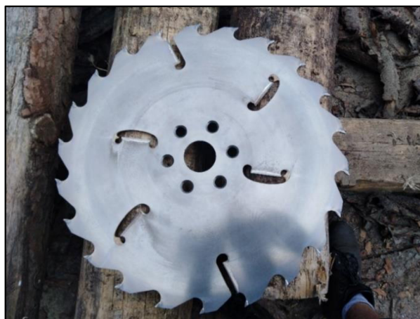
Obrázek 4 Pájený pilový kotouč
