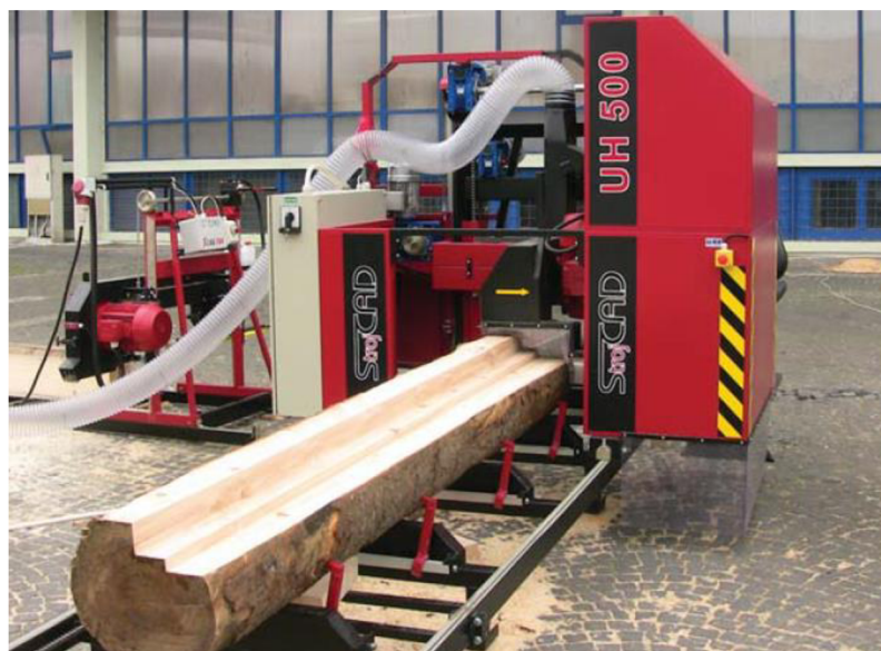
Obrázek 28 Úhlová kmenová pila Promi UH500
