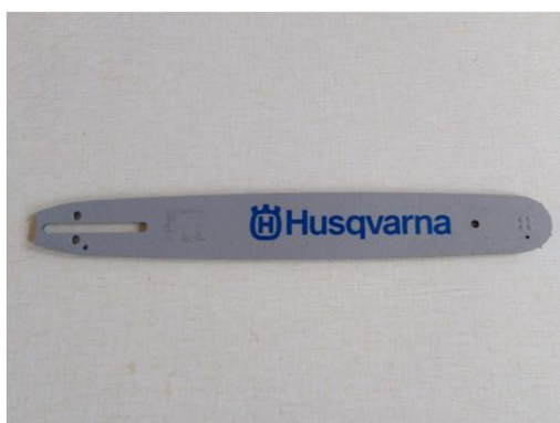
Obrázek 19 Vodící lišta Husqvarna 38 cm
