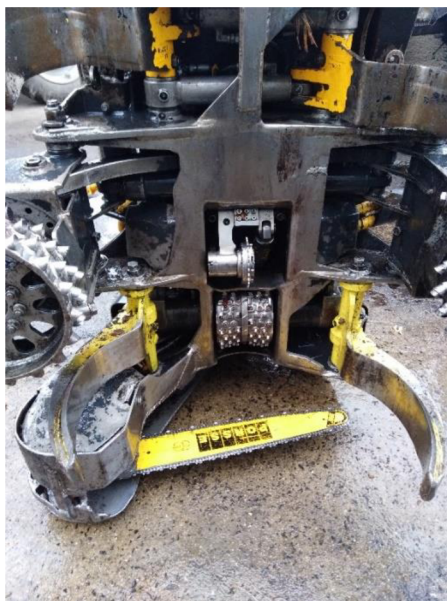
Obrázek 26 Harvestorová hlavice Ponsse s lištou a řetězem
