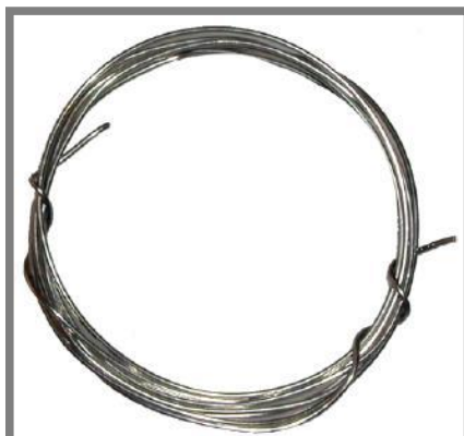
Obr. 3-6 Odporový drát z Kanthalu [28]
