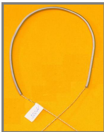
Obr. 3-14 Topná spirála o výkonu 300W [34]
