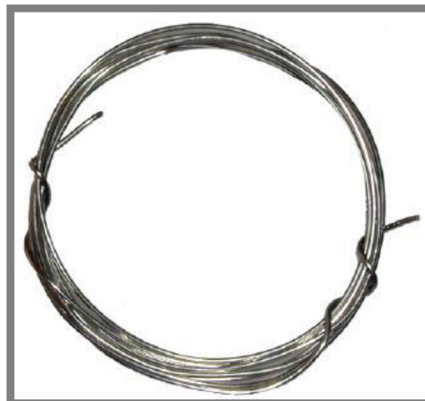
Obr. 3-6 Odporový drát z Kanthalu [28]
