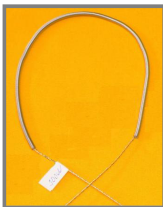
Obr. 3-14 Topná spirála o výkonu 300W [34]
