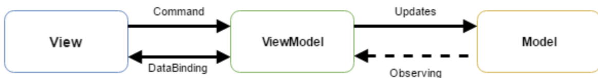
Obrázek 3.2 Zjednodušený příklad MVVM vzoru
