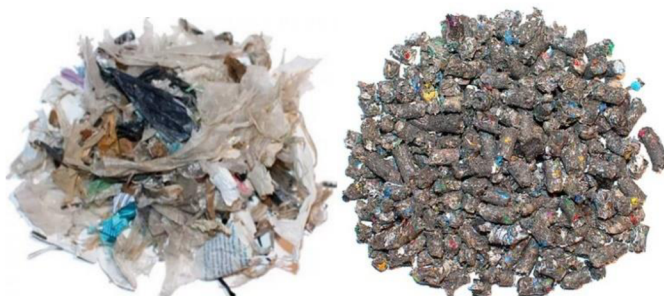
Obrázek 3: TAP v neupravené a peletované formě [11]
