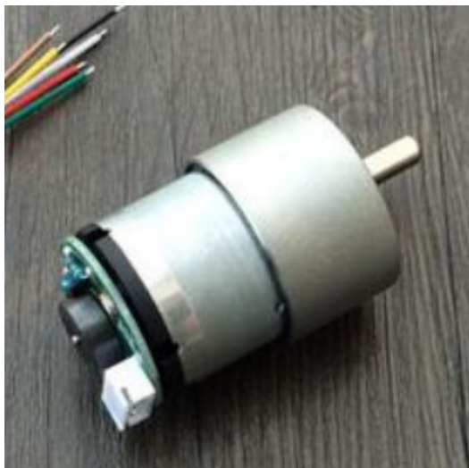
Obr. 2.3: Použitý jednosmerný motor Elecrow 3
