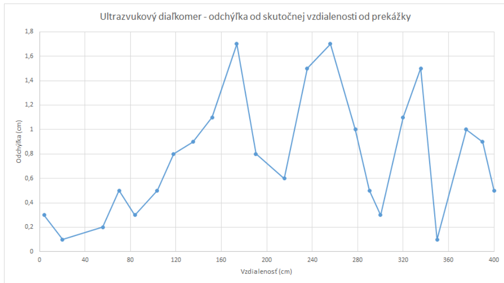
Obr. 7.1: Graf určujúci odchýlku medzi vzdialenosťou nameranou ultrazvukovým diaľkomerom a metrom
