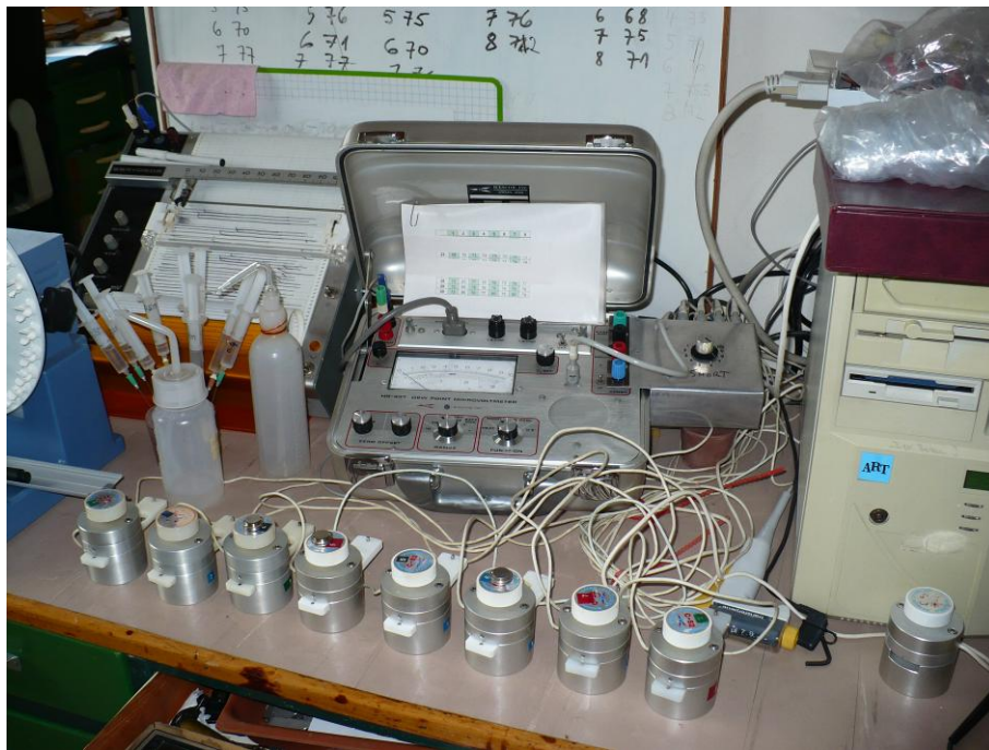
Obrázek 12. Měření osmotického potenciálu z vylisovaných buněčných šťáv pacibulek pomocí přístroje Wescor HR-33T (UT, USA) (foto autor).
