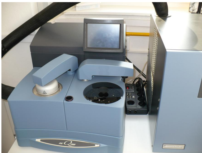
Obrázek 18. Nový typ diferenčního skenovacího kalorimetru – Q 2000, TA Instruments, pro měření termické analýzy (foto autor).
