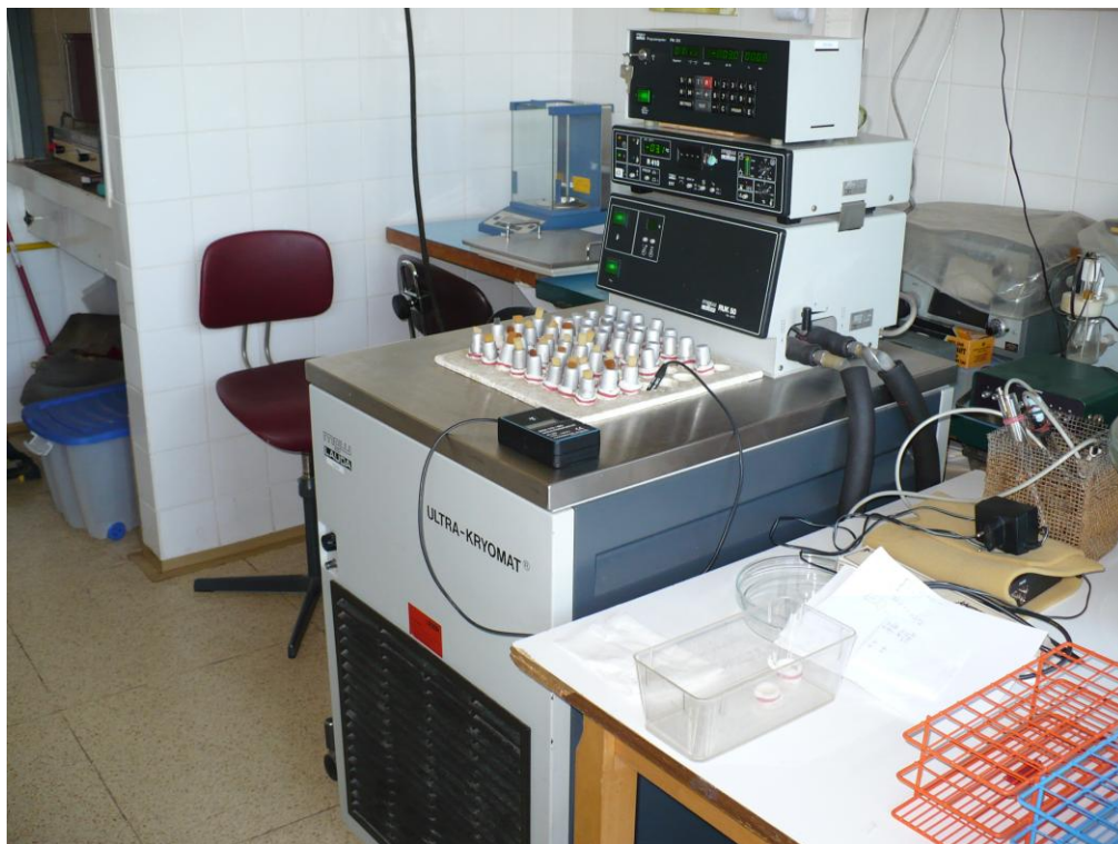
Obrázek 10. Lihová lázeň ultra-kryomatu RUK 50 (MGW LAUDA, Německo). Podchlazené a nukleované zkumavky s rostlinným materiálem jsou vystaveny nízkým teplotám mrazového testu (foto autor).
