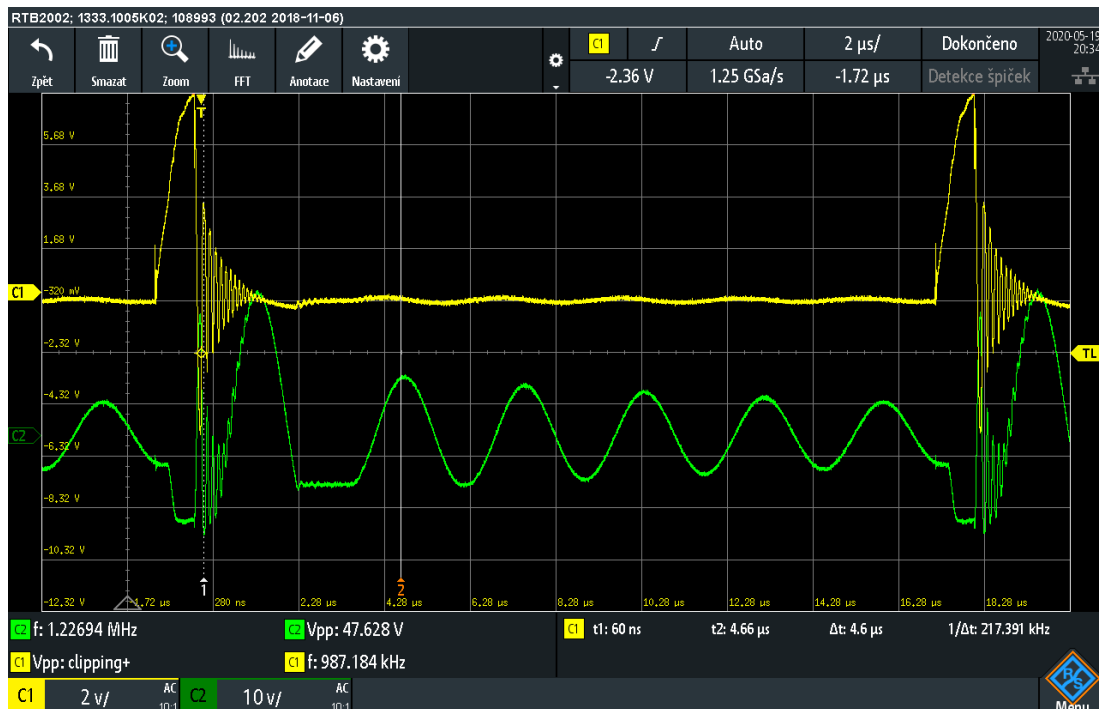
Obr. 4.3: Záznam z osciloskopu při měření spínání a napětí drain-source
