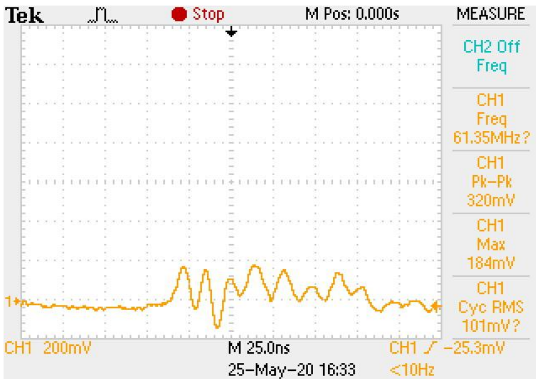
Obr. 5.3: Měření zvlnění na výstupu zdroje
