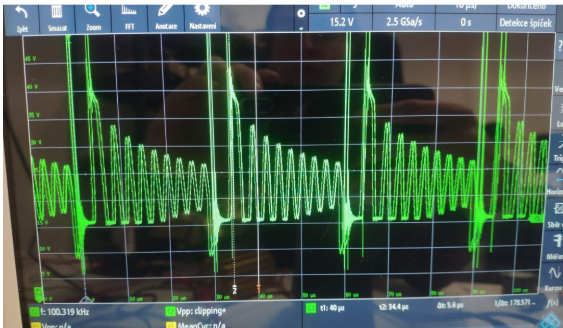
Obr. 4.4: Zákmity na drain-source při původních součástkách
