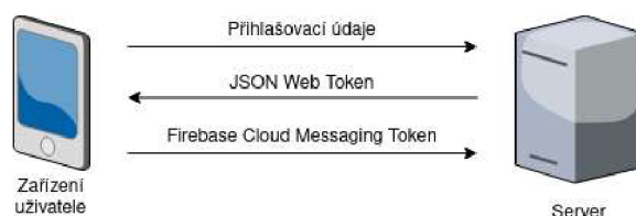
Obrázek 5.1: Znázornění komunikace server-mobilní zařízení
