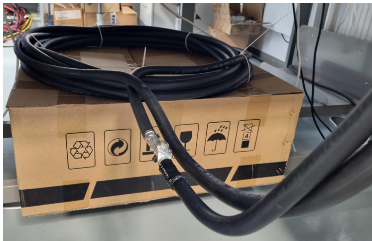
Obr. 3.8: Vzduchová cívka sloužící jako zátěž střídače
