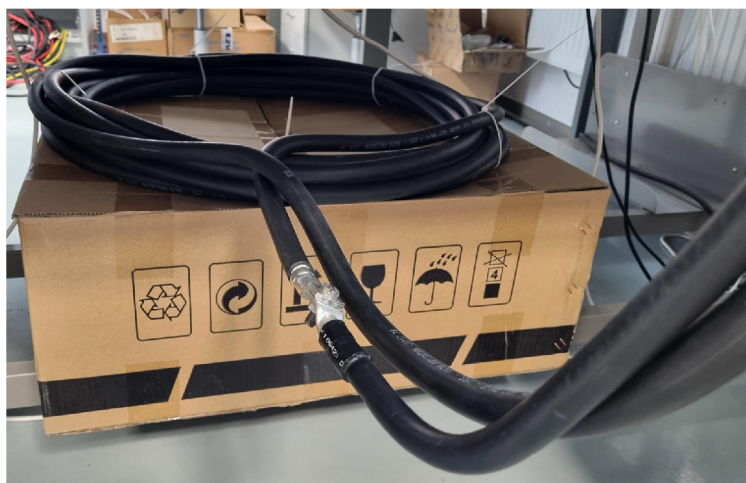
Obr. 3.8: Vzduchová cívka sloužící jako zátěž střídače
