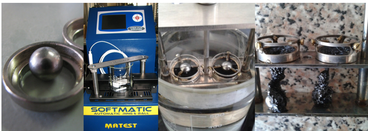
Obrázek 12: Stanovení bodu měknutí metodou kroužek kulička
