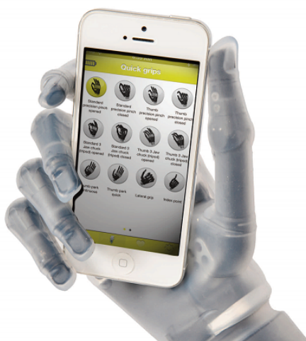
Obr. 2.7: Bionická protéza i-Limb Revolution a mobilní SW [13]
