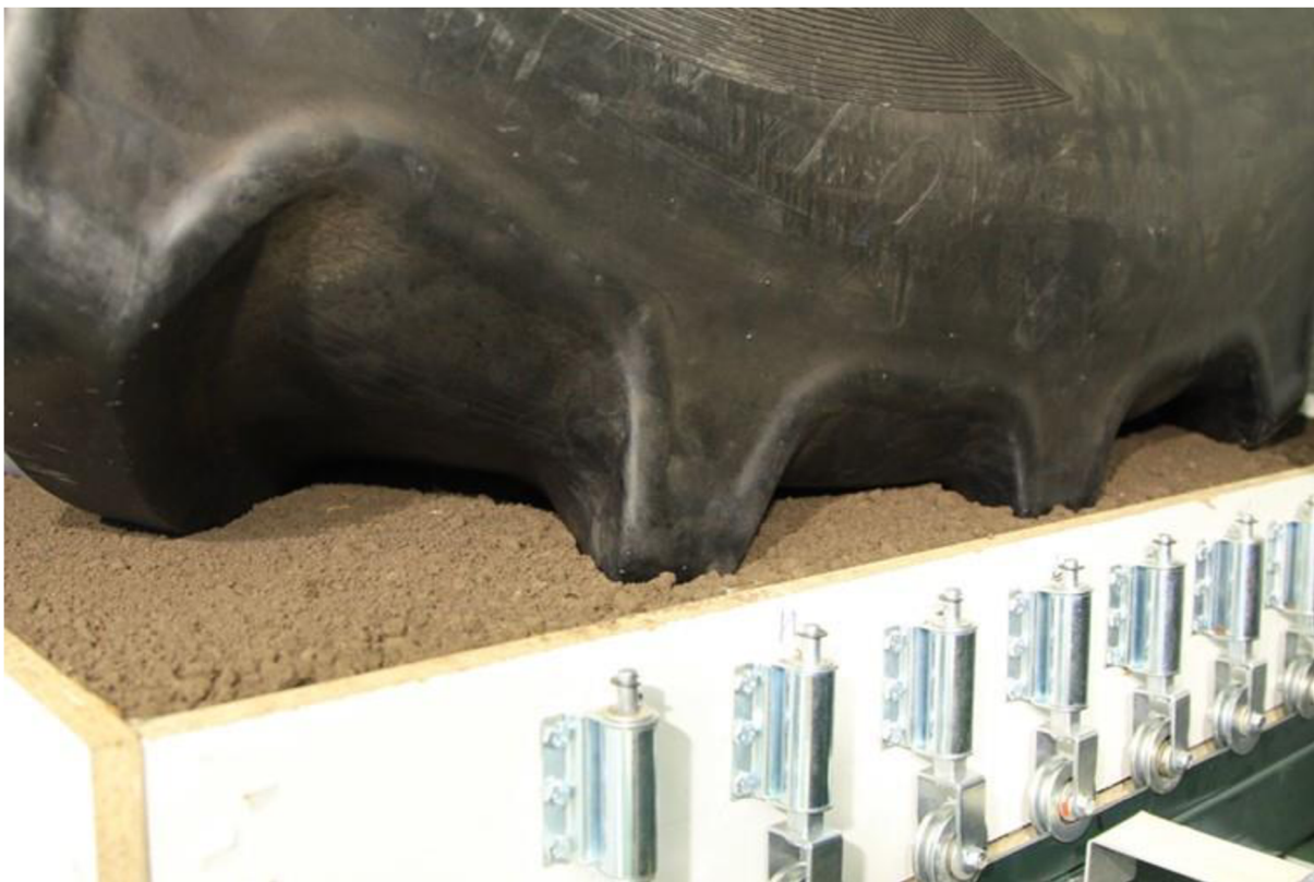
Obrázek 9: Vytvoření otisku styčné plochy pneumatiky na měkkém povrchu (mobilní půdní kontejner). (zdroj: autor)
