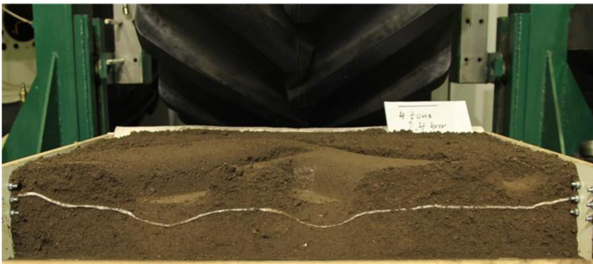
Obrázek 10: Ukázka deformace stlačených vrstev v tisku styčné plochy pneumatiky na měkkém povrchu. (zdroj: autor).
