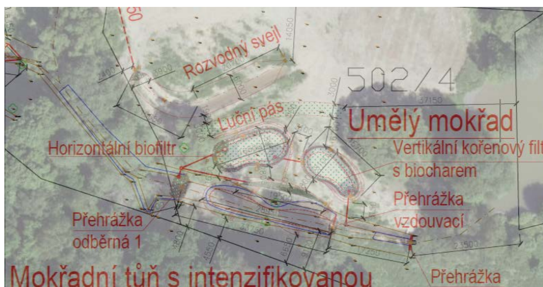
Obrázek 23: Situace překrývající topografickou mapu ČR pro porovnání navrhovaného a reálného stavu mokřadních systémů (Švejdová 2022)
